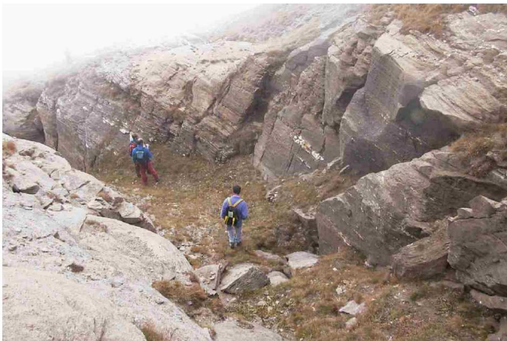
Foto n. 16: vista della trincea principale impostata nel versante a SW del P. zo del Dosso, nella tratta in cui assume andamento SW-NE. Anche dall'osservazione della presente foto si notano le numerose fratture che tagliano trasversalmente la trincea ed i consistenti depositi di riempimento presenti al fondo, inerbiti.
